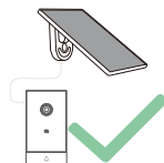
Кабель питания должен быть естественно проложен без напряжения
